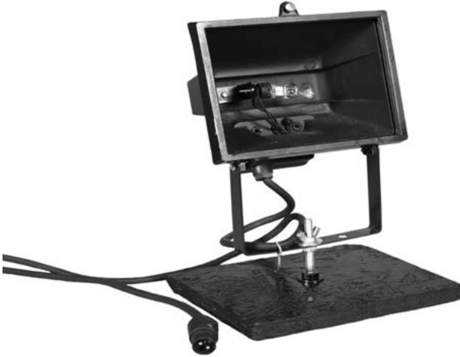
Ilustracja 1. Spreparowany reflektor służący do uzyskiwania efektów cieniowych
