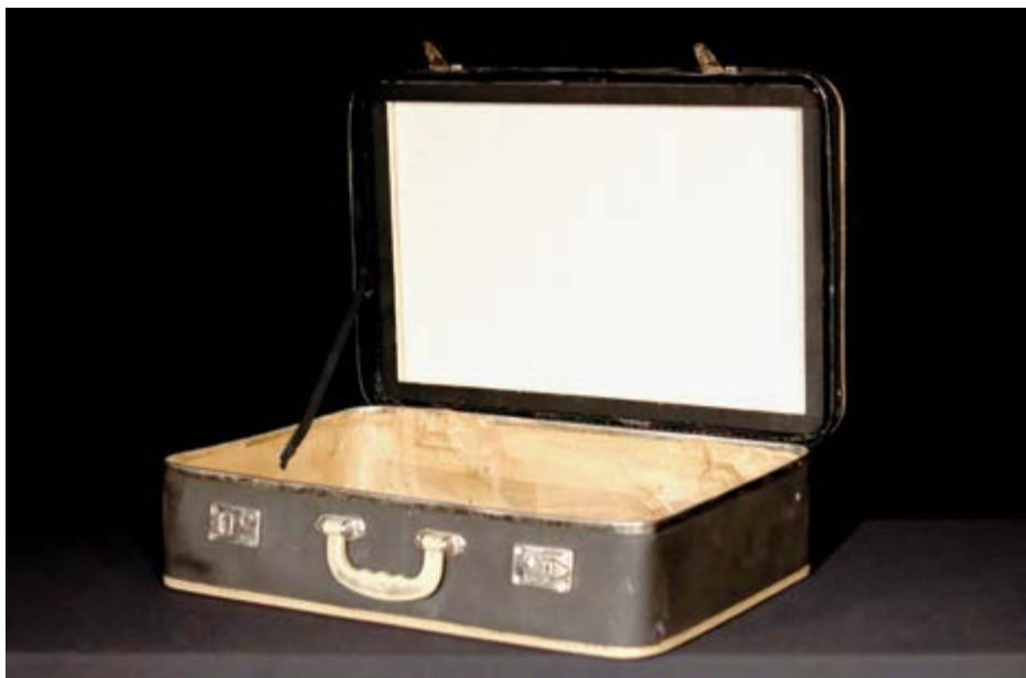
Ilustracja 18. Ekran cieniowy wykonany ze spreparowanej walizki
