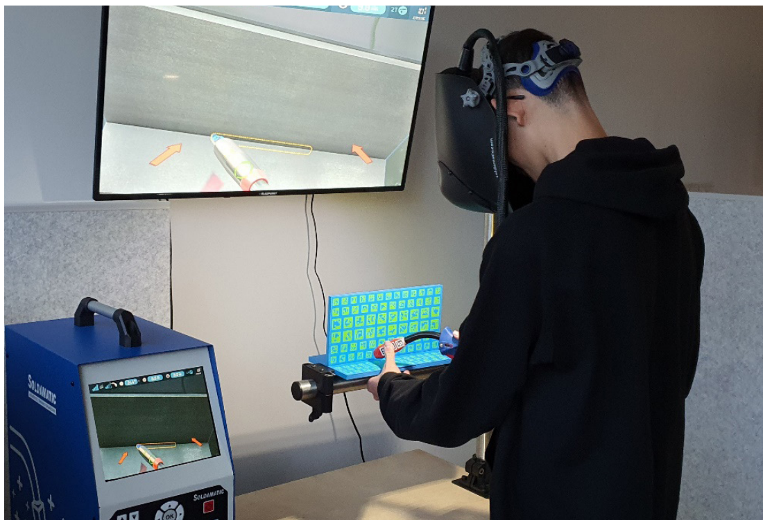
Fot. 4. Stanowisko do nauki procesu spawania, na którym wykorzystuje się technologię rozszerzonej rzeczywistości
